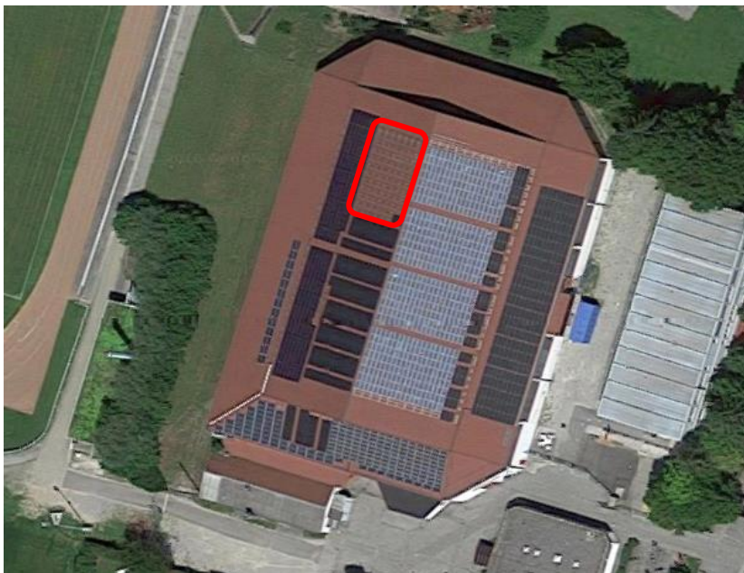
Abbildung 52 Mögliche PV-Eigenstromanlage auf der Eishalle
