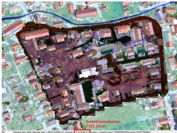
Abbildung 7: Retentionsvolumen HQ100 Plan-Zustand (großer Umgriff)
