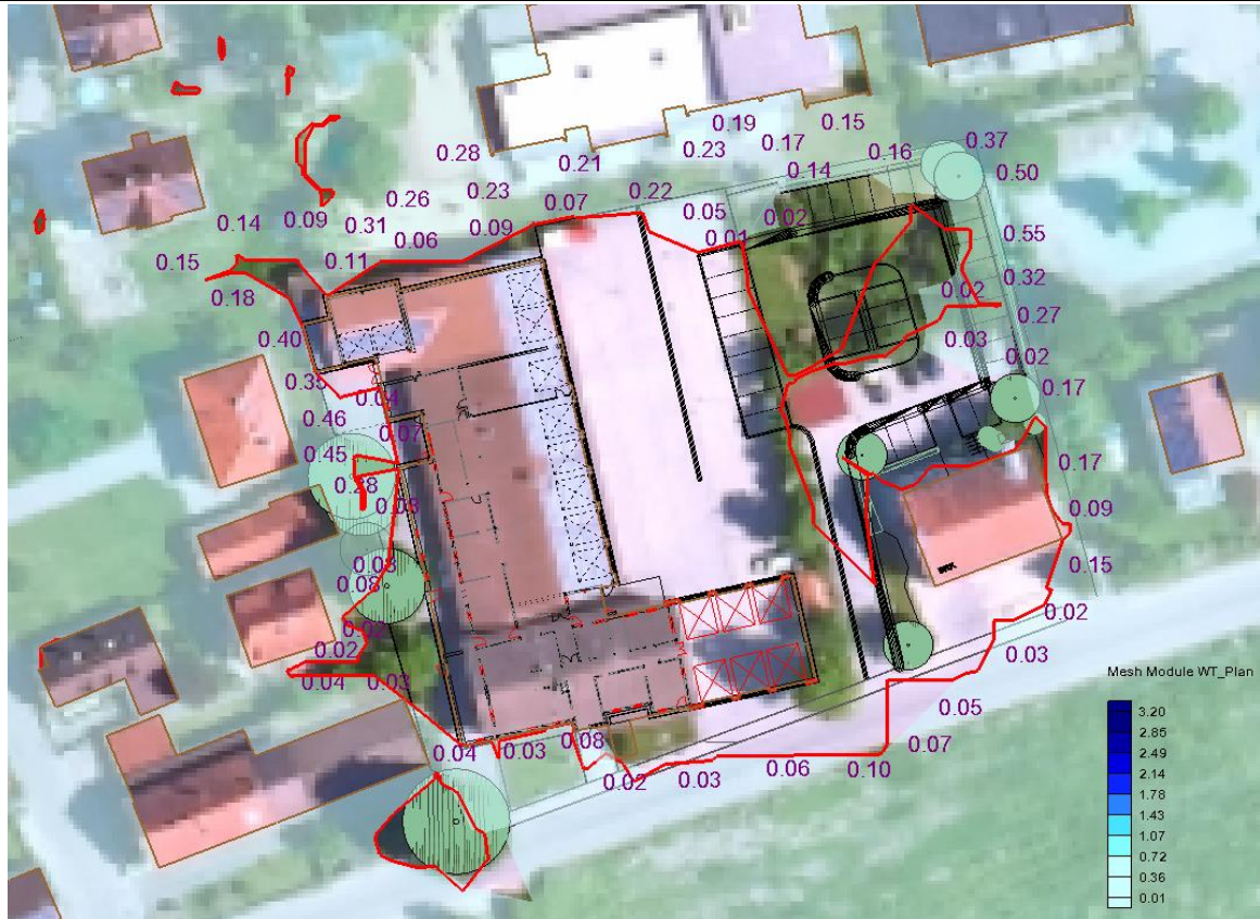
Abbildung 5: Maximale Wassertiefen bei einem HQ100-Ereignis (Plan-Zustand)
