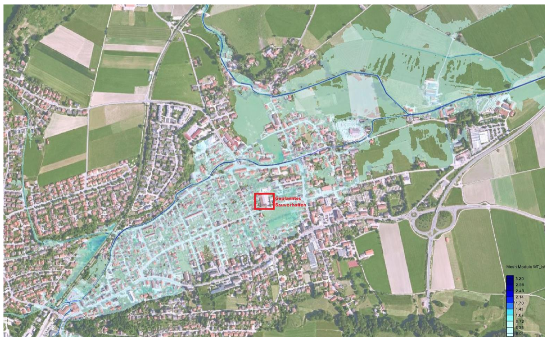
Abbildung 3: Überschwemmungssituation bei einem HQ100-Ereignis im Ist-Zustand
