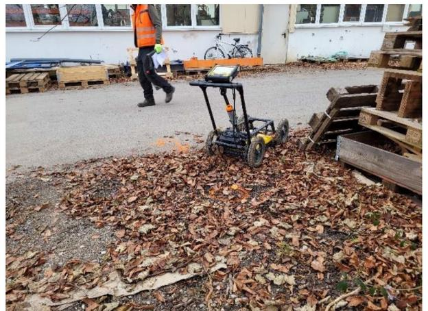
Messung des Bohransatzpunktes 6
