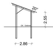
**Solar Rack langer Tisch Schnitt längs**
