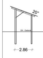
**Solar Rack langer Tisch Schnitt längs**
