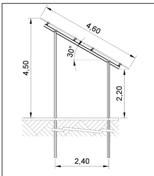
Abbildung 14: Schemaschnitt der Module; Verfasser: Energiegenossenschaft Oberland eG, o. M.
