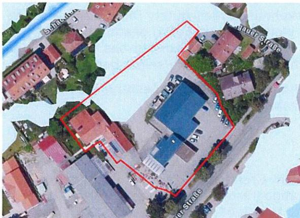
Abb. 6 Wassertiefen in der Hochwassergefahrenfläche für HQ<sub>extrem</sub>; Tiefe im Planungsgebiet: <0 m bis 0,5 m; © Bayerische Vermessungsverwaltung
