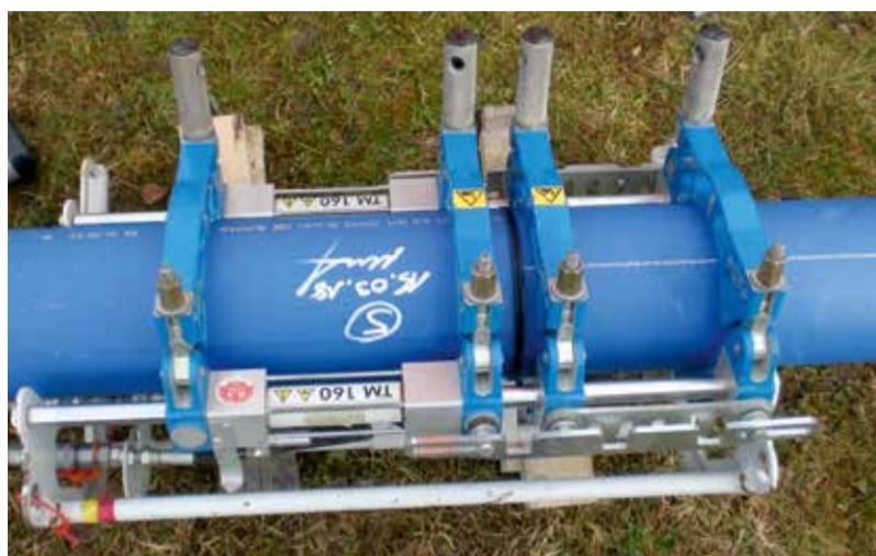
Bild 1: Herstellung einer Stumpfschweißverbindung mit Hilfe eines Stumpfschweißgeräts. Bild 2: Ein einsatzbereites Horizontalspülbohrgerät mit Bohrgestängemagazin.
