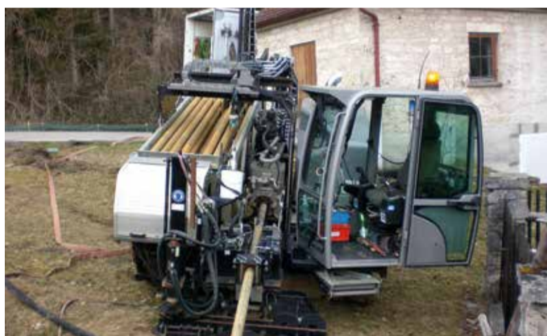
Bild 1: Herstellung einer Stumpfschweißverbindung mit Hilfe eines Stumpfschweißgeräts. Bild 2: Ein einsatzbereites Horizontalspülbohrgerät mit Bohrgestängemagazin.
